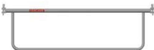
Fabricadas con tubo de  $\varnothing$  48,3 mm, permiten ahorrar tiempo en el montaje y peso. Galvanizadas en caliente con un espesor mínimo de 75 micras. Barra de protección a 0,5 m mediante tubo de  $\varnothing$  25 mm.
