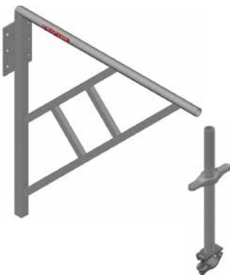
La consola de muro reforzada está fabricada en acero galvanizado en caliente. Permite montar el andamio sobre un muro o fachada, mediante anclajes químicos o mecánicos. Dispone de placa reforzada con 6 taladros de Ø 20 mm para su montaje. Longitud de voladizo: 1,3 m. El husillo de Ø 36 (600) brida Ø 48 permite iniciar sobre la consola el montaje de los elementos de inicio del sistema de andamio elegido.
