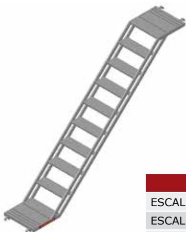
Ideales para crear accesos en estructuras de andamio. Peldaños y descansillos antideslizantes. Ancho de paso 60 y 90 cm. Los modelos fabricados en aluminio 6061 ofrecen un peso muy reducido que facilita el montaje, mientras que el modelo de acero galvanizado en caliente es ideal para accesos que requieran una elevada capacidad de carga.
